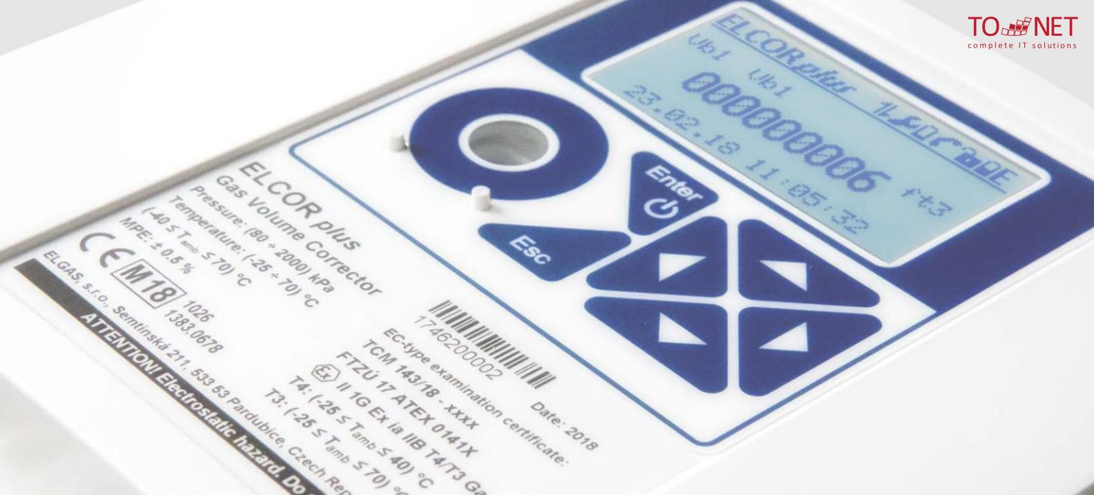
Osim metrološkog mernog dela ELCORplus može da opslužuje dva nezavisna modema za komunikaciju, interni i externi. Interni modem je modularnog dizajna i omogućava korišćenje modula za 2G,3G,4G i 4G NB mreže. Modularni dizajn omogućava laku zamenu modemima nove generacije bez narušavanja funkcionalnosti. Sve verzije, čak i sa internim modulom imaju odobrenje za instalaciju u zonama visokog rizika Ex Zona 0,1,2.
